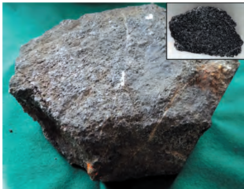
Рис. 1. Хромит густо–вкрапленный, до сплошного (1–ый образец, ГГМ, ГР–15484, размер 21.5*13*7см). На вставке полированный срез образца.
