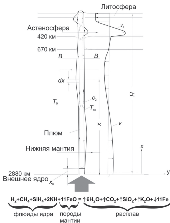
Рис 1. Схема взаимодействия канала термохимического плюма с горизонтальным мантийным течением. Структура течения в канале плюма, подверженного влиянию горизонтального мантийного течения; справа показаны профили скорости горизонтальных течений в нижней мантии ( v ) и астеносфере ( v_s ); T_{пк} – температура границы канала плюма; T_0 – температура окружающей мантии; x , dx , – переменные, характеризующие динамику подъема плюма. (Кирдяшкин А.Г., Добрецов, Кирдяшкин А.А., 2009). Внизу приведена реакция флюидов, выделяющихся из ядра, с FeO и в магнезиевюстите слоя "D" нижней мантии.
