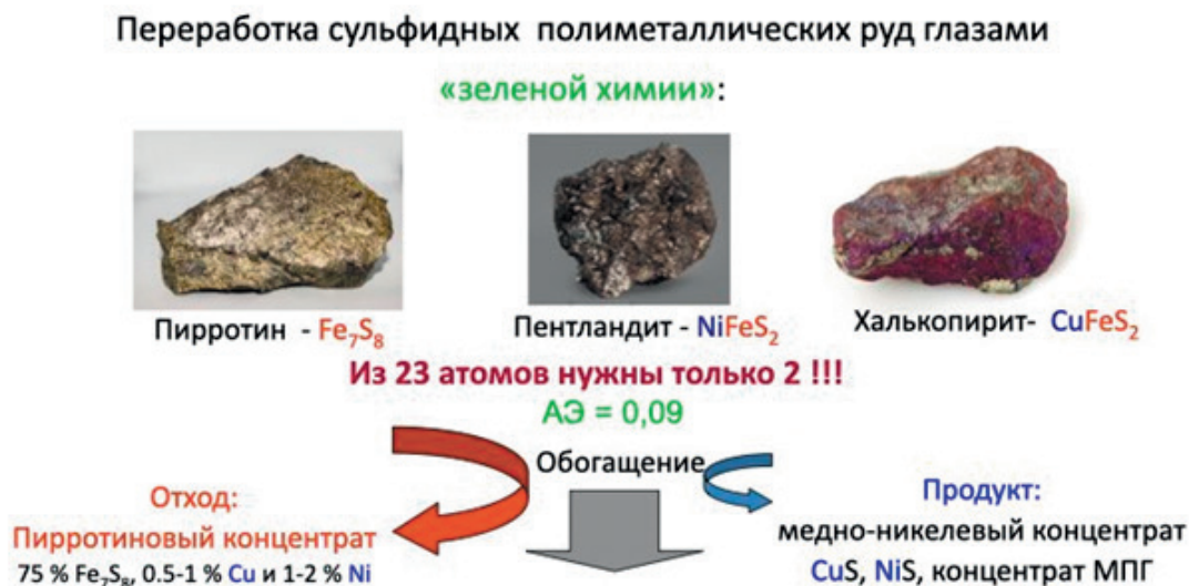
Рис. 6. Пример расчета атомной эффективности (АЭ) для процесса обогащения и выплавки меди и никеля из сульфидных руд Норильского промышленного региона.
