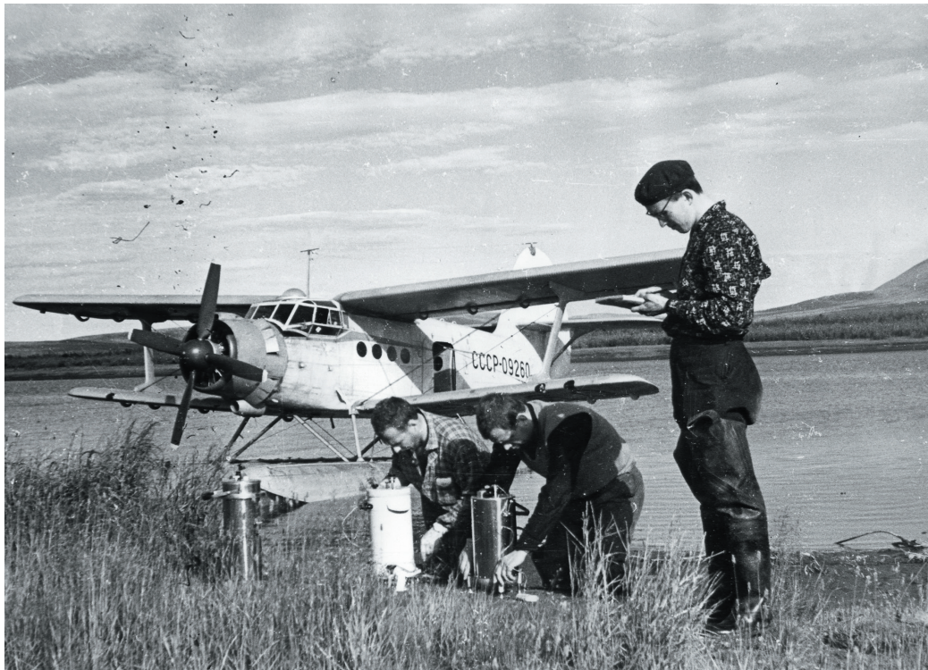
Рис. 4. Измерения поля силы тяжести при создании опорной сети. Чукотка, крайний слева – О.М. Куваев (из архива С.А. Гринь).
